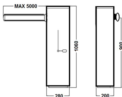
Model je vybaven enkodérem, elektromechanickými koncovými spínači, mechanickou zárazkou otevření a zavření a řídicí jednotkou s integrovaným přijímačem dálkového ovládání.
